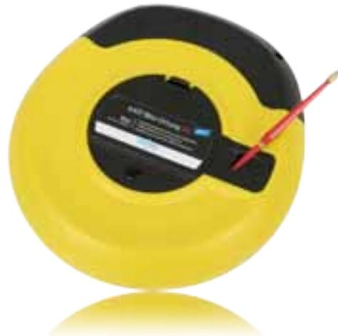
Der **Kati® Blitz Ortung 2.0** ist das Nachfolgemodell des bewährten Kabeleinzieh- und Ortungsgerätes Kati® Blitz 2in1. Ausgestattet mit einem innenliegenden Schleifringübertrager und dem hochwertigen Polykat® Glasfaserprofil mit integrierten Kupferdrähten, ermöglicht es dem Installateur nicht nur Kabel einzuziehen, sondern auch Blockaden punktgenau zu orten und Rohrverläufe nachzuvorforschen. Der Kati® Blitz Ortung 2.0 ist mit handelsüblichen Kabelsuchgeräten verwendbar.
