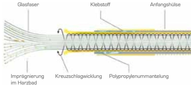
**Polykat®** Glasfaserprofil ist das Grundelement aller KATIMEX® Kabeleinziehsysteme
