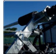
Um das Abtrommeln des Kabels von der Kabeltrommel zu erleichtern, gibt es optional einen hydraulischen Antrieb für die Trommel.
