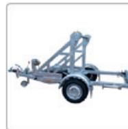
Für die größeren Anhänger mit 2500 kg, 2700 kg und 3500 kg Gesamtgewicht bietet Katimex drei verschiedene Varianten an, um Kabeltrommeln über den Kipprahmen aufzunehmen: Die Handseilwinde, eine hydraulische Handpumpe und eine Aufnahme der Kabeltrommel mit Hydraulikaggregat.
